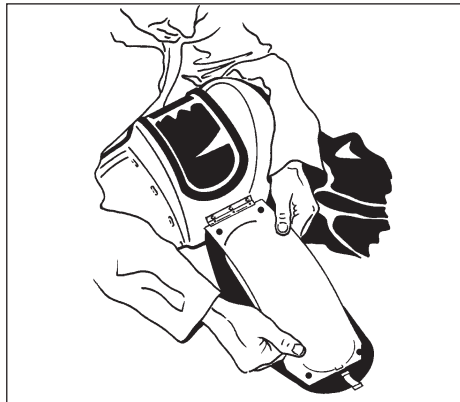
Abb. 3. Austausch der Einwegscheibe(n) Aspect
