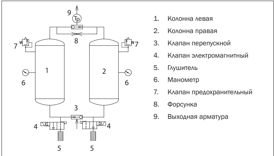
Рис. 3.5. Схема пневмотическая принципиальная
