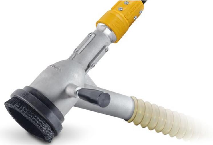
Das staubfreie Strahlsystem umfasst einen kombinierten Strahl- und Vakuum-Kopf BSH, ausgestattet mit einer Nylonborstenbürste, die gegen die Strahloberfläche drückt. Der Strahl- und Saug-Kopf BSH enthält eine Strahldüse und einen Vakuumschlauch, der Staub und das zurückprallende Strahlmittel nach dem Kontakt mit der Strahloberfläche absaugt und die Umgebung sauber hält.
