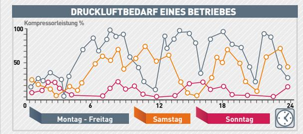
Der Druckluftbedarf eines Betriebes variiert im Laufe des Tages - von keinem Bedarf bis Spitzenverbrauch.
