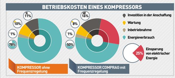
FV-Serie Kompressoren sind mit einem Frequenzrichter ausgestattet, um die Kompressorleistung entsprechend dem aktuellen Druckluftbedarf kontinuierlich zu regeln. Sie versorgen den Betrieb mit der erforderlichen Druckluftmenge bei konstantem Arbeitsdruck und verbrauchen dabei nur so viel elektrische Energie, wie Druckluft benötigt wird. Diese Funktionsweise sorgt für ein maximales Energie Ersparnis.
