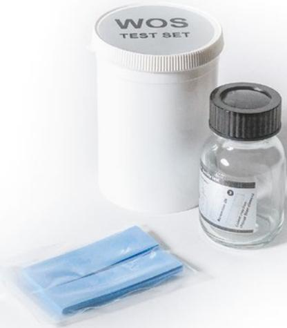
Ein WQT-Wasserqualitätstest sollte mindestens einmal monatlich durchgeführt werden, um den Verschmutzungsgrad des entsorgten Kondensats zu kontrollieren.
